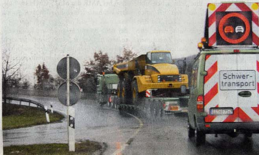
Das erste, was Autofahrer sehen, ist das Begleitfahrzeug BF3, das sie auf einen schweren Baumaschinentransport aufmerksam macht. Hier befördert Wacker einen Dumper des Bauunternehmens Leonhard Weiss, der in Coburg für den Neubau der A 73 gebraucht wird.
